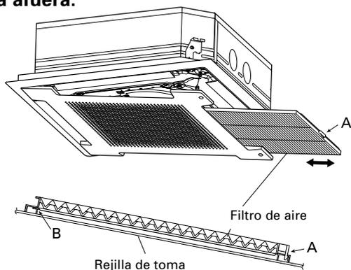
4. Al volver a instalar el filtro, asegúrese de que los enganches que hay en A y B (véase la figura) quedan correctamente acoplados en su sitio.
