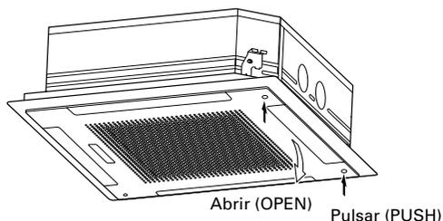
3. Sujete el enganche (haciendo presión hacia abajo) que hay en A y tire del filtro hacia afuera.
