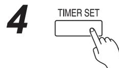
Pulse el botón **TIMER SET** (AJUSTE TEMPORIZADOR) durante 2 segundos o más para completar el ajuste de **DÍA APAGADO**.
