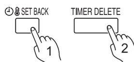
Pulse el botón SET BACK (AJUSTE ANTERIOR) y, a continuación, pulse el botón TIMER DELETE (BORRADO DEL TEMPORIZADOR) mientras se muestra la pantalla de confirmación del ajuste anterior (SET BACK). Incluso si se vuelve a pulsar el botón SET BACK (AJUSTE ANTERIOR), se cancelará el temporizador AJUSTE ANTERIOR.
