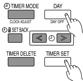
Нажмите одновременно кнопку отключения DAY (DAY OFF) и кнопку настройки SET на 2 секунды или более для активирования функции ограничения доступа детей и блокировки всех кнопок на пульте дистанционного управления. Нажмите эти кнопки на 2 секунды или более для отмены этого режима.
