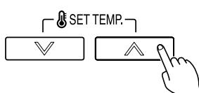
Нажмите кнопки установки температуры для настройки температуры. (Диапазон температур такой же, как и для установок режима работы).
