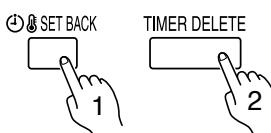
Нажмите кнопку SET BACK, а затем кнопку DELETE до появления индикатора подтверждения режима SET BACK. Даже при повторном нажатии кнопки SET BACK таймер режима специальной температуры SET BACK будет отключен.
