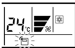
Нажмите кнопку включения экономичного режима работы (ECONOMY) более 2 секунд, чтобы выбрать место определения комнатной температуры: на внутреннем устройстве (дистанционный датчик) или на пульте дистанционного управления.
