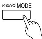
Pulse el botón de control de funciones para ajustar el modo de funcionamiento. Si selecciona deshumectación (DRY), la velocidad se ajustará en automático (AUTO).
