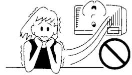
No inserte los dedos ni otros objetos en el orificio de salida ni en las rejillas de entrada.
