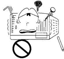
No debe poner en funcionamiento el acondicionador de aire ni pararlo enchufando y desenchufando el cable de la alimentación.
