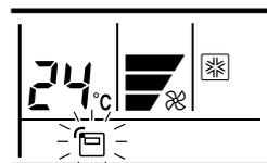
Tenere premuto il tasto ECONOMY (RISPARMIO ENERGIA) per più di 2 secondi per selezionare il sensore della temperatura presso l'unità interna (sensore remoto) o presso l'unità di controllo remota.
