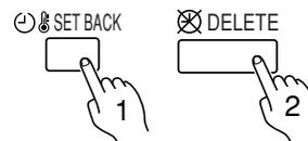
Appuyez sur le bouton SET BACK (ABAISSEMENT), puis appuyez sur le bouton DELETE (SUPPRIMER) lorsque l'affichage de confirmation SET BACK (ABAISSEMENT) apparaît. Même si le bouton SET BACK (ABAISSEMENT) est enfoncé à nouveau, la minuterie d'ABAISSEMENT sera annulée.
