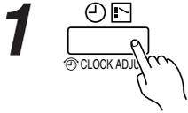
**1** Appuyez sur le bouton timer mode (CLOCK ADJUST) (Mode minuterie (REGLAGE DE L'HORLOGE)) pendant au moins 2 secondes. L'affichage de l'heure sur la télécommande clignote.
