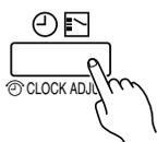
Appuyez sur le bouton du mode minuterie pour sélectionner la minuterie MISE EN MARCHE ou la minuterie ARRET.
