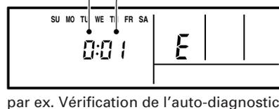
**3** Appuyez simultanément sur les boutons de réglage de la température pendant au moins 5 secondes pour arrêter l'auto-diagnostic.
