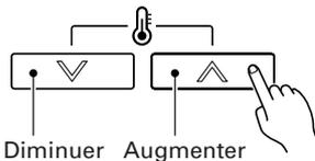
Appuyez sur les boutons de réglage de la température pour régler la température de la pièce.
