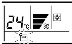
Appuyez sur le bouton THERMO SENSOR (CAPTEUR THERMIQUE) pour indiquer si la température de la pièce doit être détectée sur l'unité d'intérieur (capteur distant) ou sur la télécommande.
