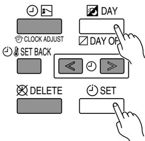
Appuyez sur le bouton DAY (DAY OFF) (JOUR (JOUR ARRET)) et le bouton SET (REGLER) simultanément pendant 2 secondes minimum pour activer la fonction de contrôle parental et verrouiller tous les boutons de la télécommande. Appuyez de nouveau sur les boutons pendant 2 secondes minimum pour désactiver la fonction de contrôle parental.
