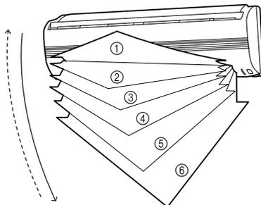
● Sélectionnez une des positions de réglage de la direction du flux d'air représentées ci-dessus.
