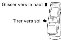
③ Pour retirer la télécommande (contrôle télécommande en main).
