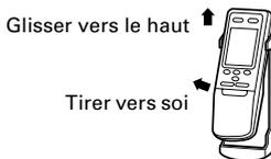
③ Pour retirer la télécommande (contrôle télécommande en main).
