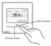
Die LED-Leuchte bleibt eingeschaltet, während das Innengerät in Betrieb ist.
