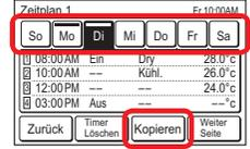
Berühren Sie als Nächstes den Wochentag, bei dem die Daten eingefügt werden sollen. Wenn [Einfügen] berührt wird, wird eine gepunktete Linie über dem Wochentag angezeigt, bei dem eingefügt werden soll. Fahren Sie fort, zu anderen Tage der Woche einzufügen.
