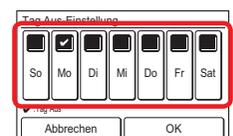
Berühren Sie nach dem Abschluss der Einstellung [OK]. Nachdem der Bildschirm zum Abschluss der Einstellung angezeigt wird, kehrt die Anzeige zum Bildschirm „Wtl. Timer Ein.“ zurück.
