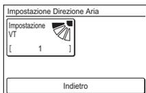
Quando il telecomando è collegato all'unità interna a cassetta con funzione di controllo del flusso d'aria individuale, [Impostazione individuale VT] viene visualizzato.
