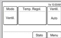
• Quando "Auto" viene selezionato in "Unità interna Master", "Auto" viene visualizzato sulla schermata della modalità di monitoraggio dell'unità interna secondaria.
