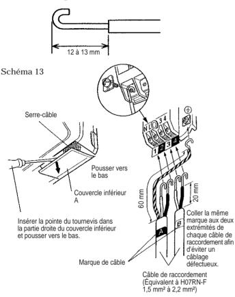
(Retirer le panneau frontal en se référant à la section " (2) RETIRER LE PANNEAU FRONTAL " incluse dans ce manuel.)
