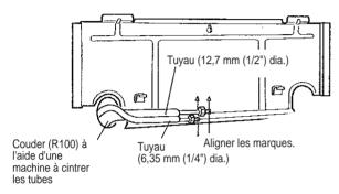
Les travaux de tuyauterie se réaliseront plus aisément si le tuyau de raccordement, le tube de drainage et le câble de raccordement sont étalés, modelés et assemblés au préalable comme indiqué sur le schéma 10.
