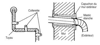
(5) Fixer le tube de drainage au mur extérieur, etc.
