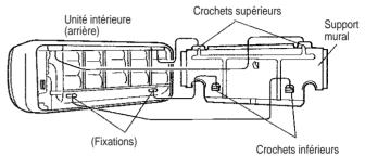
Après avoir suspendu l'unité intérieure aux crochets supérieurs, accrocher les attaches de l'unité intérieure aux deux crochets de la partie inférieure tout en rabaissant l'unité et la poussant vers le mur.
