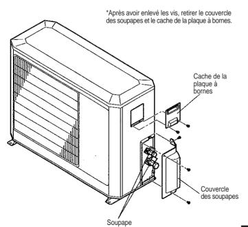
(2) Raccorder la tuyauterie, le câble de raccordement et le cordon d'alimentation électrique.
