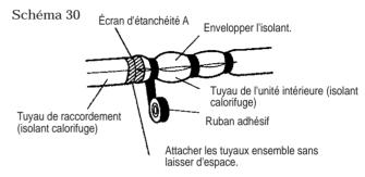
Pour la tuyauterie gauche et arrière gauche, envelopper la zone qui abrite la section de tuyauterie arrière avec un adhésif à support toile. Puis soulever légèrement l'unité intérieure et la rabaisser en la poussant vers le mur. Accrocher ensuite les deux crochets situés sur la partie inférieure du support mural dans les trous prévus à cet effet.
