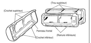
(2) Vérifier que les crochets supérieurs sont bien placés dans les trous supérieurs et que les crochets inférieurs sont bien placés dans les rainures inférieures.
