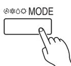
Premere il tasto MODE (MODALITÀ) per impostare la modalità di funzionamento. Se è selezionata la modalità DEUMIDIFICAZIONE, la velocità del ventilatore sarà impostata su AUTO.
