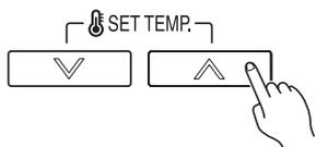
Premere i tasti SET TEMP. (IMPOSTAZIONE TEMP.) per impostare la temperatura. (l'intervallo di impostazione della temperatura è identico a quello della modalità di funzionamento).
