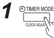
Premere il tasto TIMER MODE (CLOCK ADJUST) [MODALITÀ TIMER (REGOLAZIONE DELL'OROLOGIO)] per almeno 2 secondi. L'indicazione dell'ora sul telecomando lampeggia.
