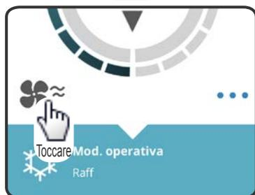
Selezionando ciascuna voce indicata sulla schermata, è possibile impostare la velocità del ventilatore e la direzione del flusso dell'aria.
