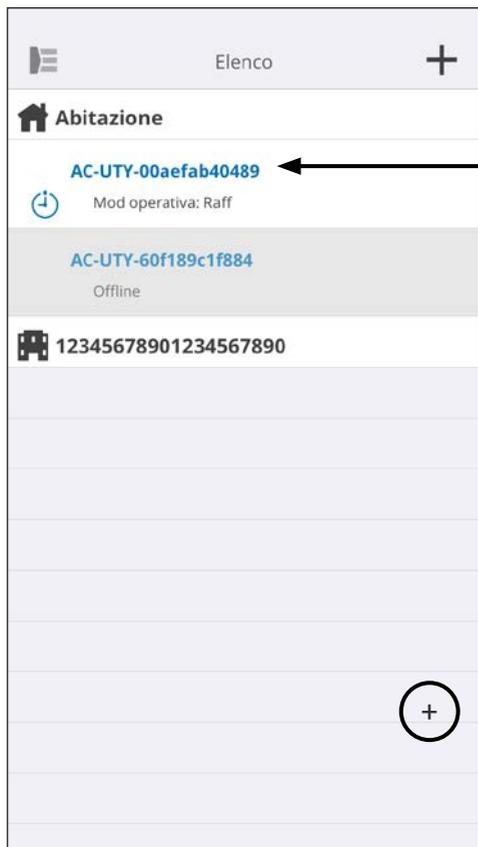
Verrà visualizzato lo stato di ciascun condizionatore d'aria collegato. (On/Off, Modalità operativa, Timer, Errore)
