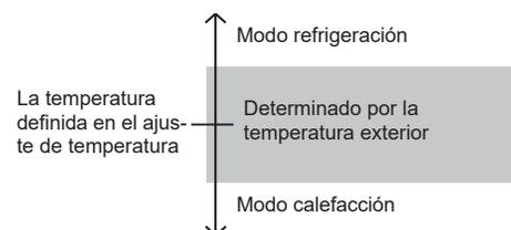
Al seleccionar Auto mode (modo automático) por primera vez, el ventilador funcionará a velocidad muy baja durante unos minutos, mientras la unidad interior determina las condiciones de la habitación y selecciona el modo de funcionamiento adecuado.
