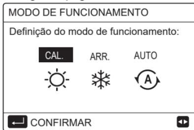
Existem três modos de funcionamento na interface do controlador: Modo de AQUECIMENTO, modo de ARREFECIMENTO e modo AUTOMÁTICO. Utilize "◀", "▶" para selecionar o modo e prima "←".
