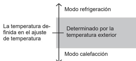
En las siguientes situaciones, el acondicionador de aire inicia el funcionamiento del monitor para seleccionar el modo de funcionamiento. Durante el funcionamiento del monitor, el ventilador gira a baja velocidad y se detiene intermitentemente.
