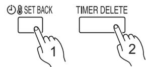
Pulse el botón SET BACK (AJUSTE ANTERIOR) y, a continuación, pulse el botón TIMER DELETE (BORRADO DEL TEMPORIZADOR) mientras se muestra la pantalla de confirmación del ajuste anterior (SET BACK). Incluso si se vuelve a pulsar el botón SET BACK (AJUSTE ANTERIOR), se cancelará el temporizador AJUSTE ANTERIOR.
