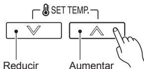
Pulse los botones de SET TEMP. (ajuste de temperatura) para ajustar la temperatura de la sala.
