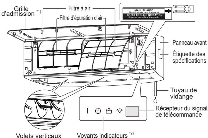
\*1) Avant de démarrer l'appareil, vérifiez que la grille d'admission est complètement fermée. Une fermeture incomplète risque d'affecter le bon fonctionnement ou les performances de l'appareil.
