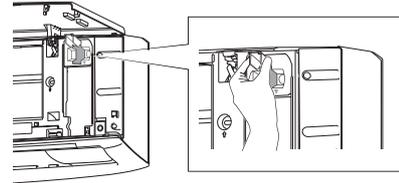
4. Retirez l'adaptateur de réseau local sans fil de la fente de connexion de l'unité intérieure dans le sens indiqué sur la figure.
