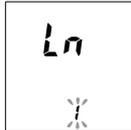
2. Appuyez sur **SEND** sur la télécommande et maintenez-la enfoncée pendant plus de 5 secondes. **Ln** apparaît sur l'affichage de la télécommande.
