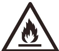
O aparelho deve ser armazenado numa divisão onde não existam fontes de ignição em funcionamento contínuo (por exemplo: chamas nuas, um aparelho a gás em funcionamento ou um aquecedor elétrico em funcionamento).
